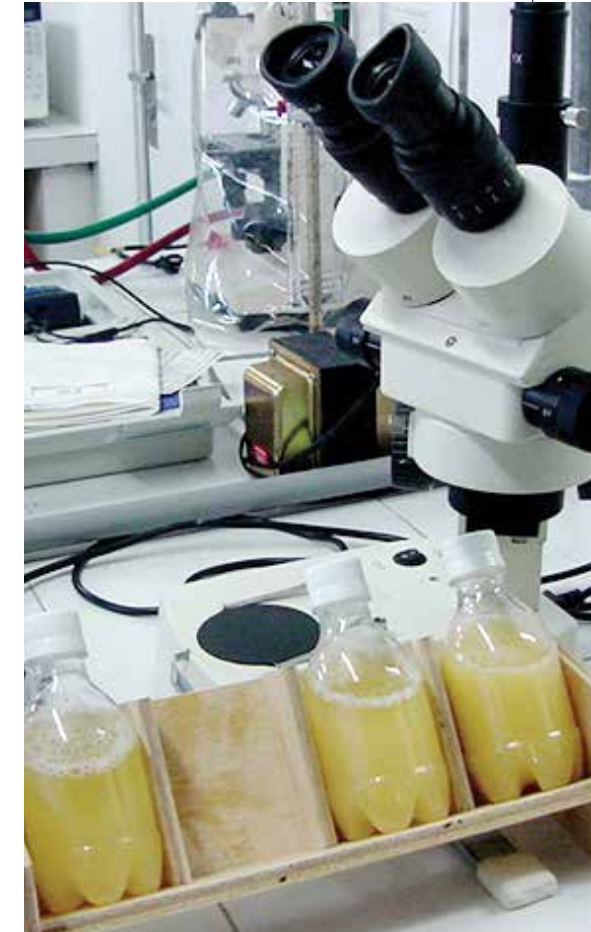
Leitura do crescimento do fungo na superfície do suco, usando lupa
